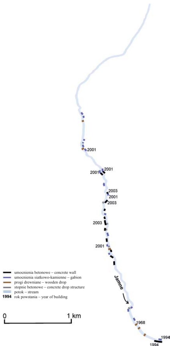
Rys. 3. Umocnienia hydrotechniczne w korycie potoku Jamne (stan z 2008 roku) Fig. 3. Hydrotechnical structures in channel of Jamne stream (2008)
