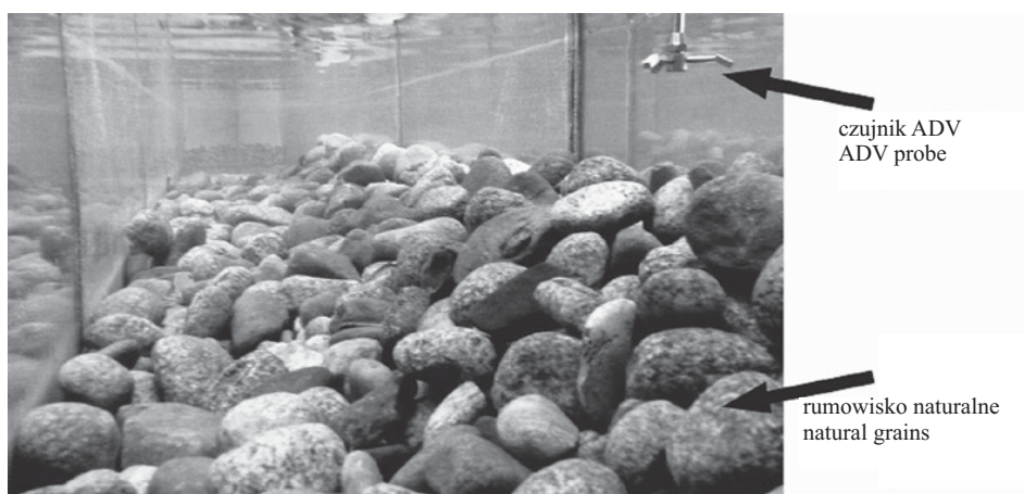
Rys. 1. Model fizyczny połowy przepławki w formie bystrza o zwiększonej szorstkości Fig. 1. Physical model of the half part of the rough stream shaped fish ladder
