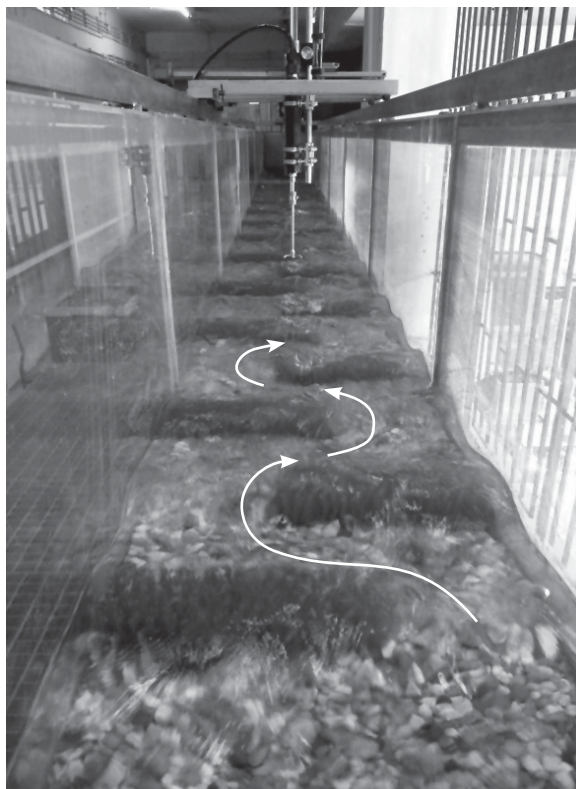
Rys. 2. Kanał migracji ryb na modelu przeplawki dwufunkcyjnej
