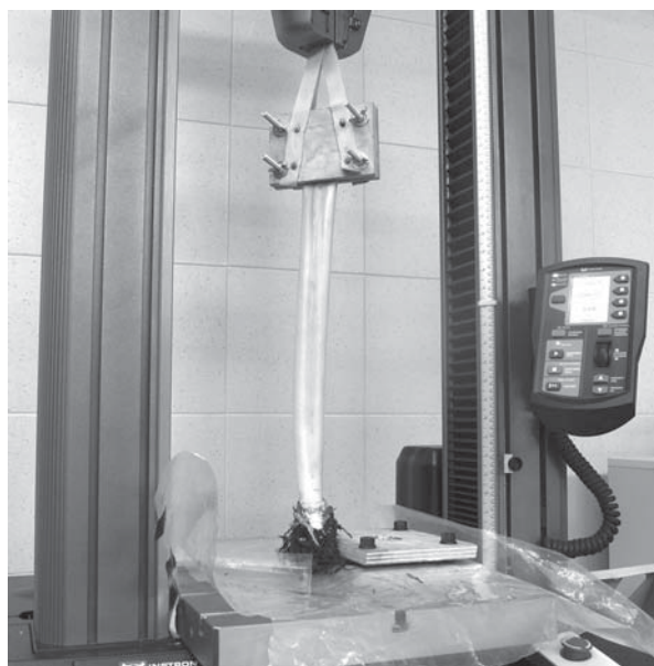
Rys. 1b. Pomiar wytrzymałości na rozciąganie nasady pędu nadziemnego Fig. 1b. Measurement of tensile strength for base of shoot
