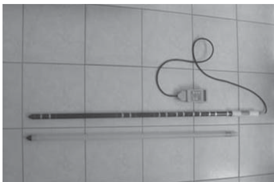
Fig. 1. ADR sensor with profile probe Rys. 1. Czujnik ADR z sondą profilu
