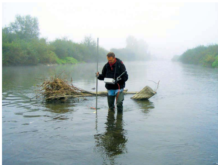
Ryc. 4. Pomiary hydrometryczne w rejonie rumoszu drzewnego zdeponowanego w rzece Rabe w celu określenia parametrów hydrodynamicznych (fot. B. Radecki-Pawlik)
