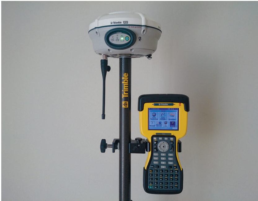
Ryc. 3. Zestaw pomiarowy Trimble R8 GNSS z kontrolerem TSC2
