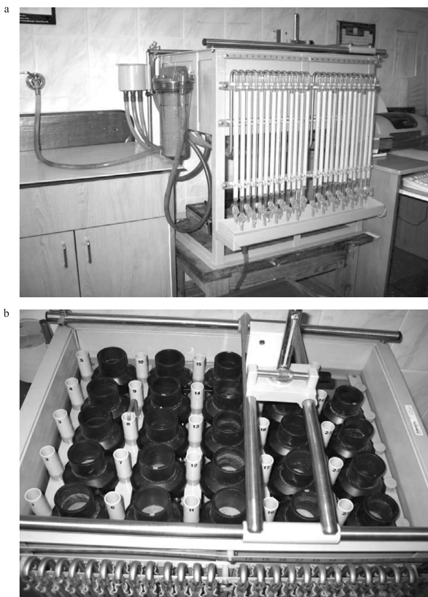
Rys. 2. Przepuszczalnościomierz firmy Eijkelkamp: a – elementy składowe urządzenia, b – próbki w uchwytach mocujących w zbiorniku głównym
